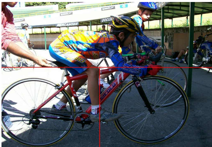
Foto N° 12. Ciclista con posición defectuosa en la que el sillín esta corrido hacia la parte trasera la plomada se ubica detrás del eje central.
