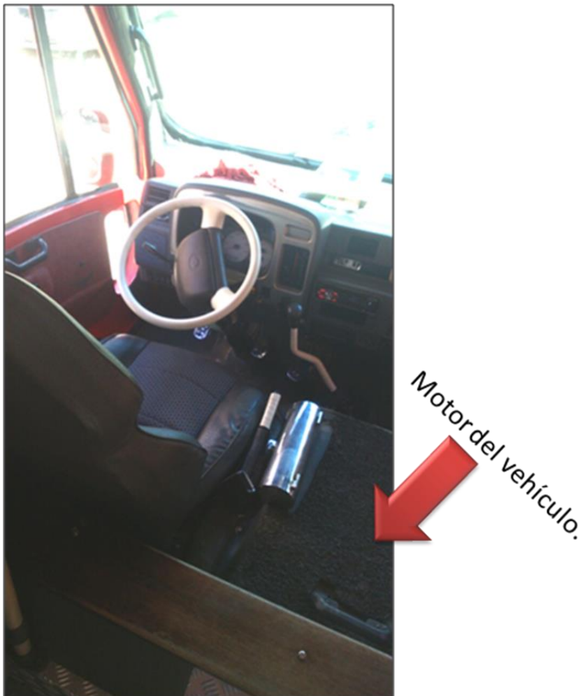
Figura 1. Localización del motor del vehículo
