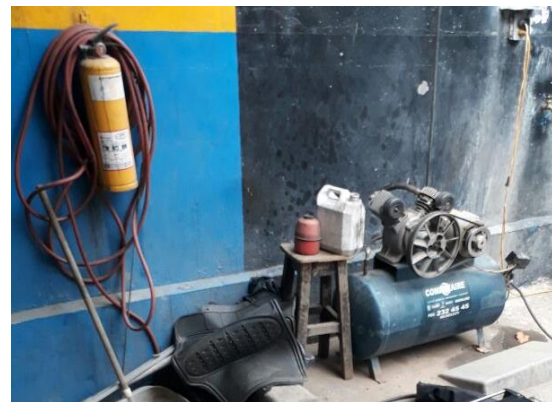
Figura 5. Máquina: Compresor, que genera ruido de forma considerable; lo cual puede causar cefaleas.
