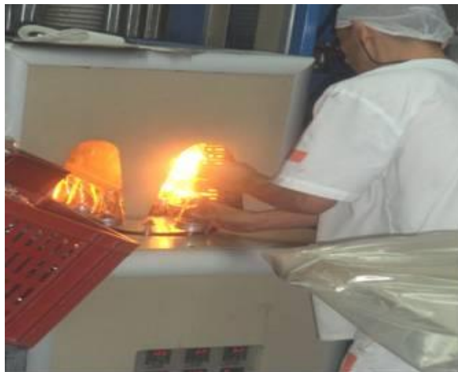
Operario organizando las preformas en la máquina para darle la forma deseada. Fuente: elaboración propia.
