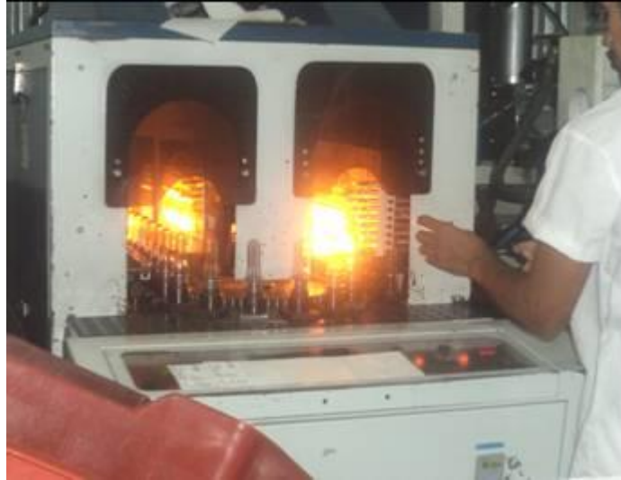
Operario realizando la actividad de darle forma a los envases en la sopladora. Fuente: elaboración propia.
