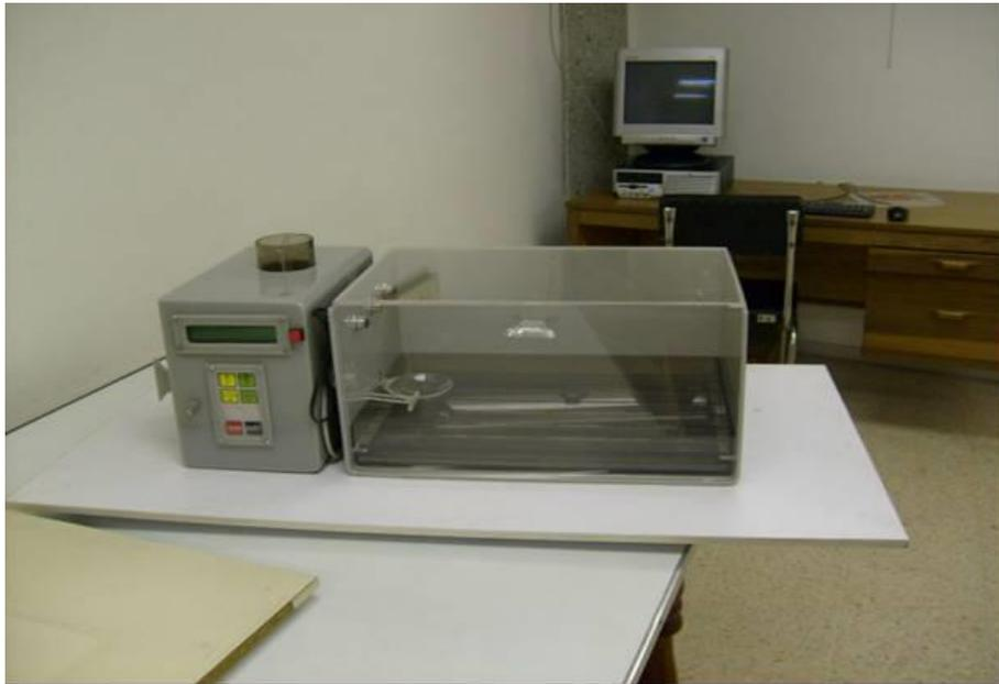
FOTOGRAFÍA # 3: CAJA DE SKINER ELECTRÓNICA
